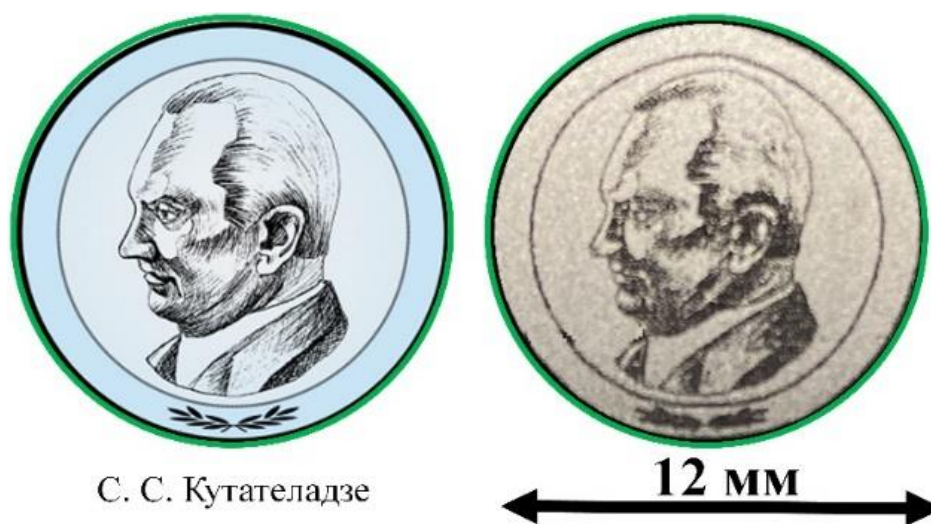
Рисунок 2.13. Обработка кремниевой мишени по заданному шаблону
